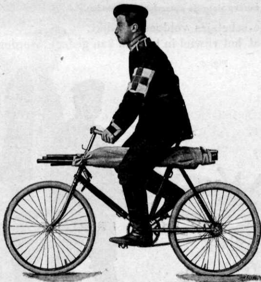
Het rijwiel in normalen toestand, voorzien van brancard en bereiden door een hospitaalsoldaat of ziekendrager.
