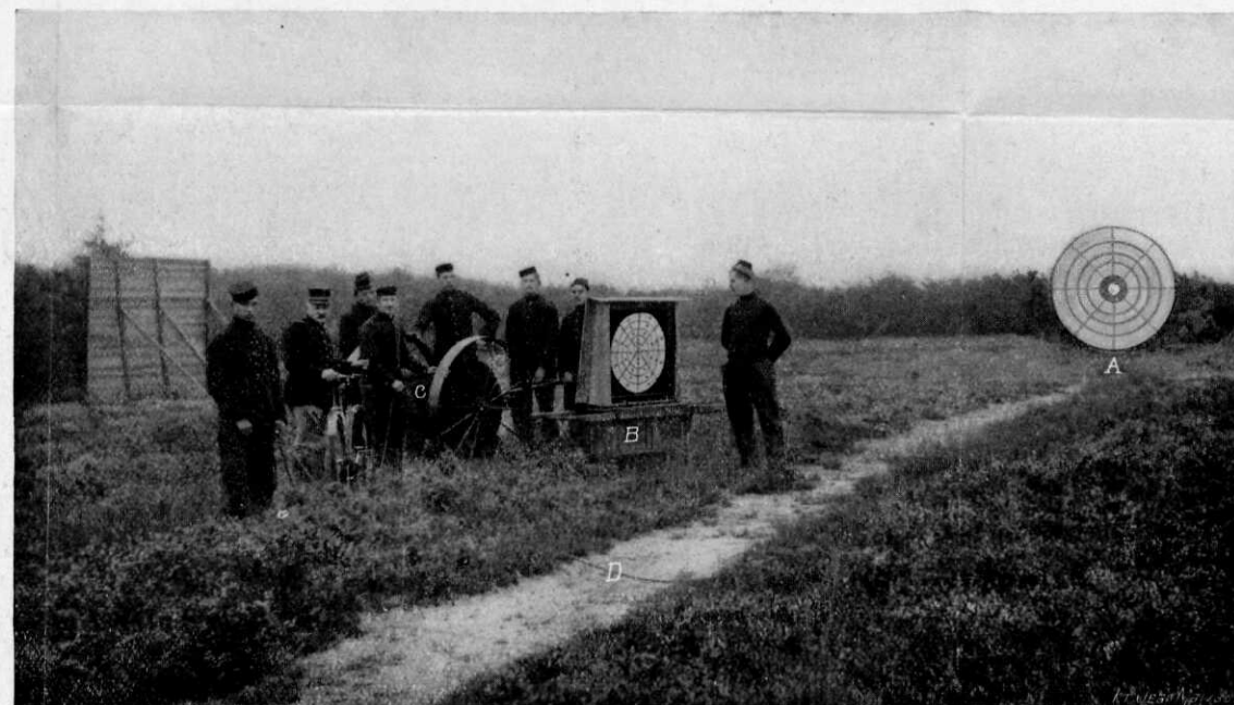
FIG. 6. Schijf met verplaatsbaren aanwijzer en kabelkar, in gebruik te Beverloo.
