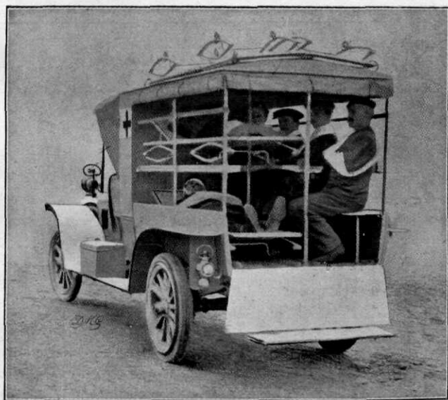
Daimler-automobiel voor het vervoer van 4 liggende gewonden, of van 8 zittende, of van 2 liggende en 4 zittende.
