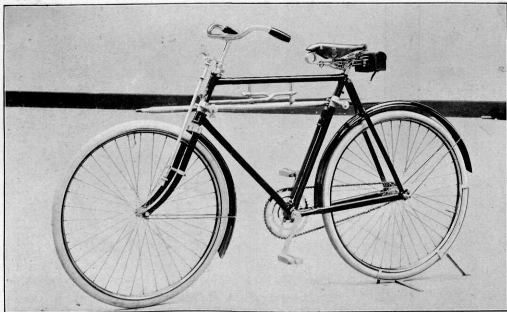
Ontkoppeld rijwiel met de helft der koppel- en draagstangen van de rijwielbrancard NORD.
