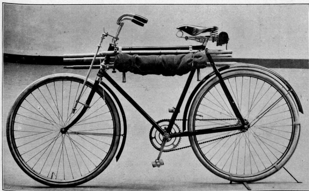
Ontkoppeld rijwiel met de helft der koppel- en draagstangen en de helft der draagbaar van de rijwielbrancard NORD.
