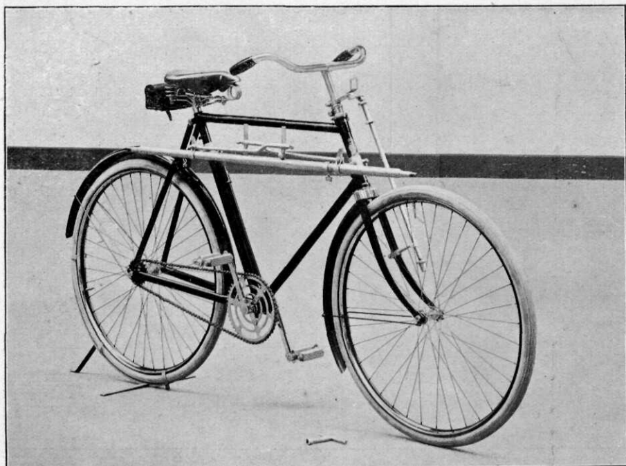
Ontkoppeld rijwiel met de helft der koppelstangen van de rijwielbrancard NORD.
