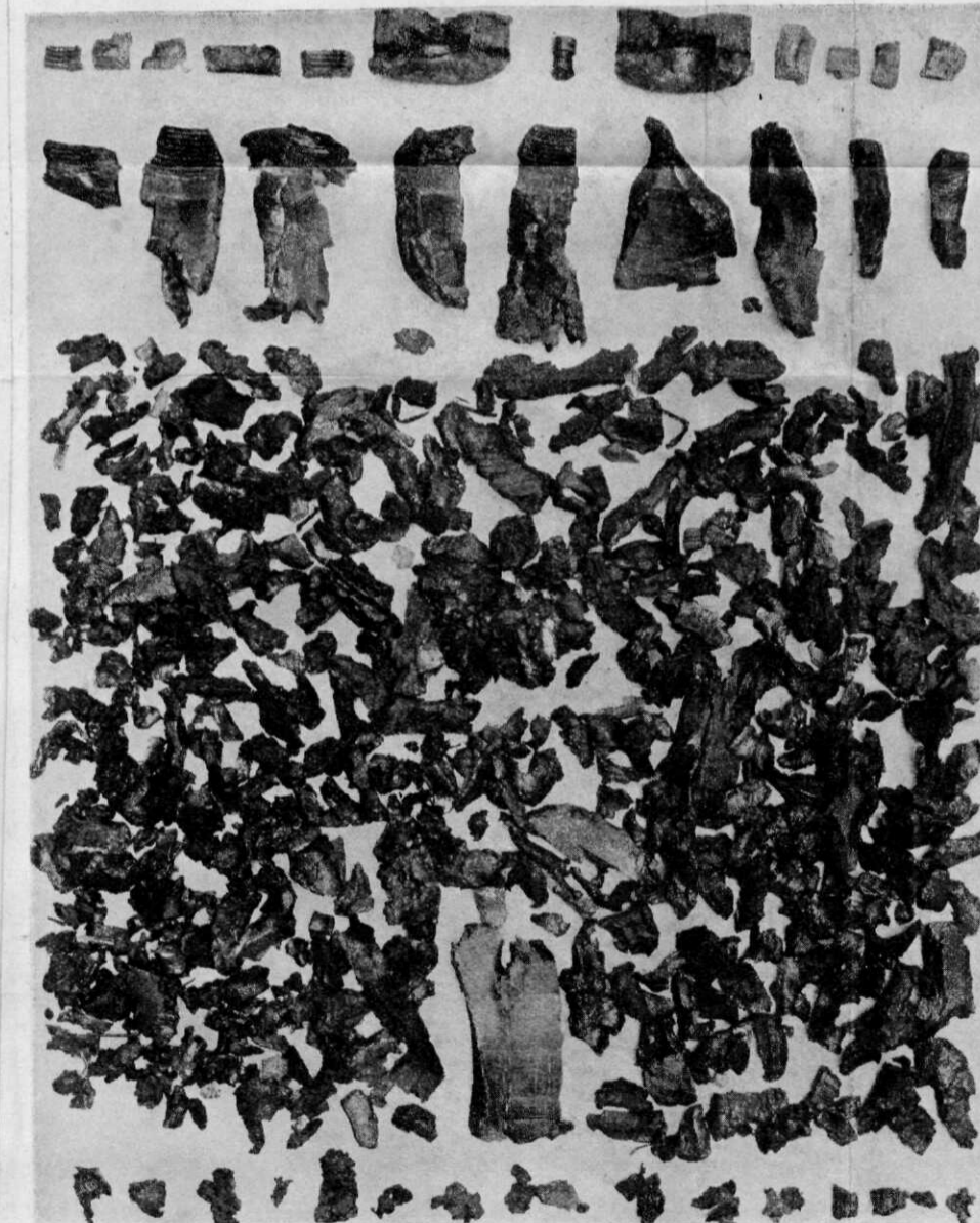
De scherfwerking van een in een kuil gesprongen projectiel C.
