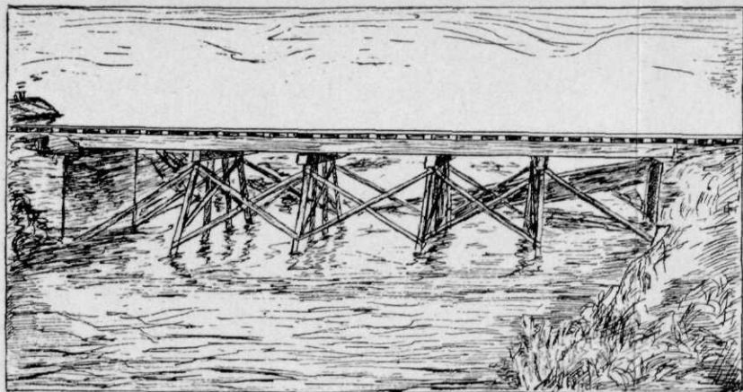
Fig. 1. Hulpbrug van eenvoudige jukken met houten liggers.
