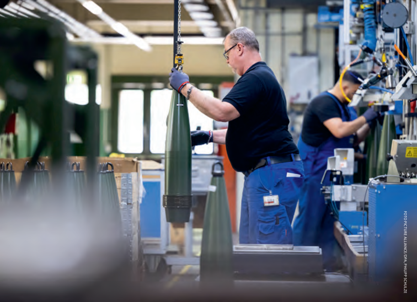
Productie van 155mm-artilleriegranaten bij Rheinmetall, 2023: voor de lange termijn is opschaling van de productiecapaciteit van de industrie cruciaal
