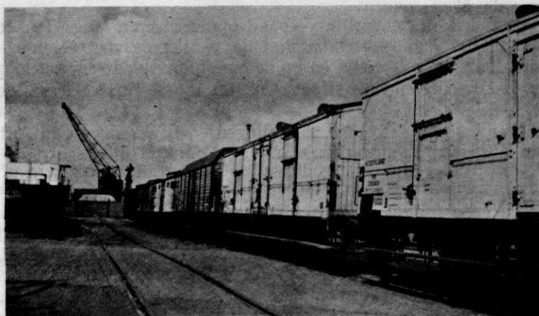
Beginpunt. Gedeelte van den eersten levensmiddelen trein bij vertrek uit de verplegingsbasis naar het Veldleger. De voor vleeschvervoer ingerichte witte wagons werden in de warme zomerdagen gekoeld met koolzuursneeuw, hetwelk, in tegenstelling met ijs, het vochtgehalte in den wagon laag houdt.
