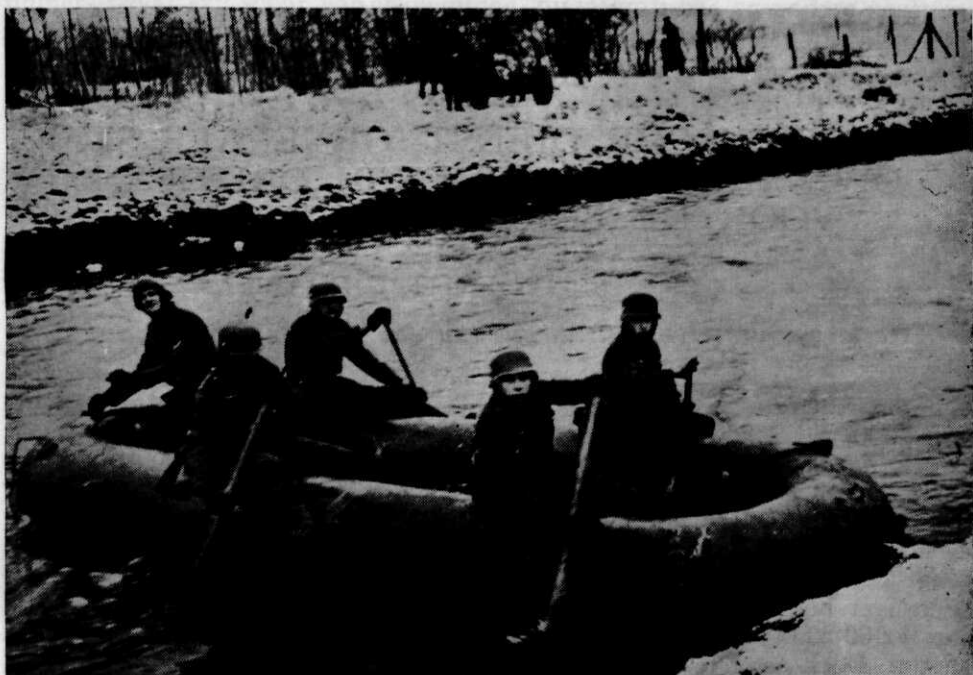
Groote drijfzak, zooals in gebruik bij het Duitse leger, waarmede \frac{1}{2} groep of 1 zwaar infanteriewapen met bediening kan worden overgezet.
