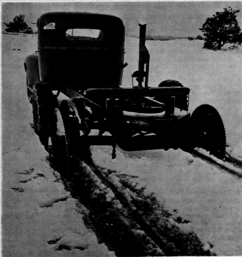
Ijszaag van VAN DOORNE's Aanhangwagenfabriek N.V. die in het geïnnundeerde gebied gebruikt werd om het ijs in stukken te zagen, die dan tot barricaden werden opgestapeld.
