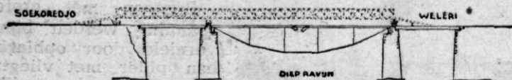
Afb. 16: Over de in het midden van de hoofdoverspanning doorgestagen brug over de Kali Dessa (Z.W. van Semarang), waarvan ook het Z. landhoofd (Soekoredjo-zijde) vernield werd, sloegen de genietroepen tijdens actie een Baileybrug
