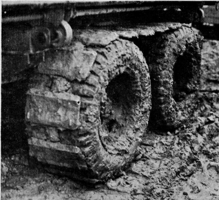
Afb. 2. Met Pionier Truck Tracks beschermde banden zakken in zachte bodem niet weg.
