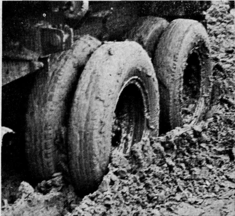
Afb. 1. Onbeschermde autobanden zakken diep weg in een zachte bodem.
