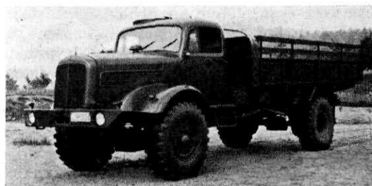
Afb. 12 Mercedes Benz militaire vrachtwagen 4 X 4. Netto laadvermogen: op de weg en in het terrein 5000 kg; M.B. motor 145 pk.
