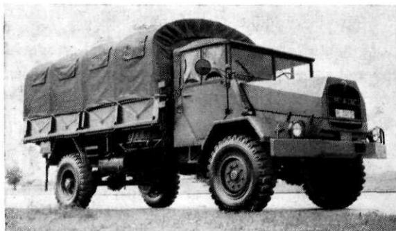
Afb. 1 M.A.N. militaire vrachtwagen 4 × 4. Netto laadvermogen: op de weg 3100 kg; in het terrein 3100 kg; M.B. motor 100 pk.
