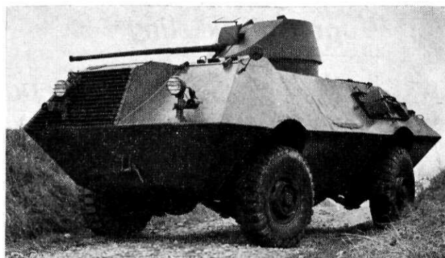
Afb. 4 Gepantserd wielvoertuig met 2 cm Oerlikon mitrailleur (foto Mowag)
