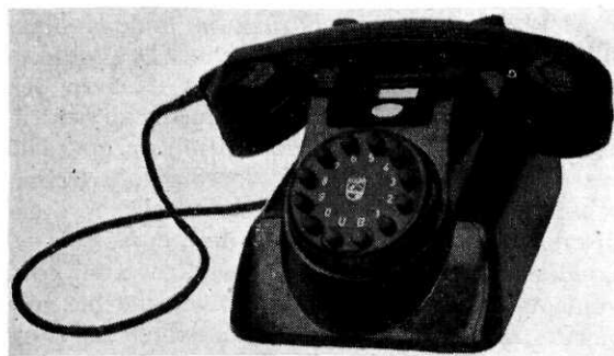
Afb. 6 Conventionele telefoon; bij wijze van proef door Philips van drukknopsignalering voorzien
