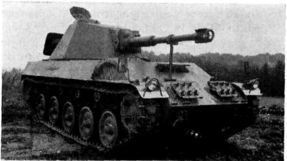
Afb. 2 Gepantserd antitank-voertuig Mot. Pak Pirat (foto Mowag )
