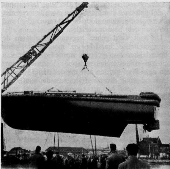
Tewaterlating van de bruggebouwboot. De fraaie lijn van de boot en de stuurschroef zijn goed te zien
