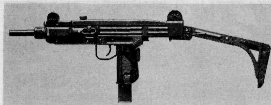
Afb. 2 De UZI-pistoolmitrailleur met uitgeklapte kolf (foto FN)
