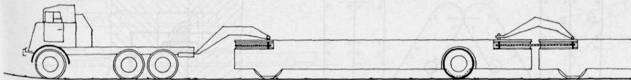
Afb. 6 Amphibische ponton, afm. 12 × 3 × 1,6 m, gewicht ca. 12 t
