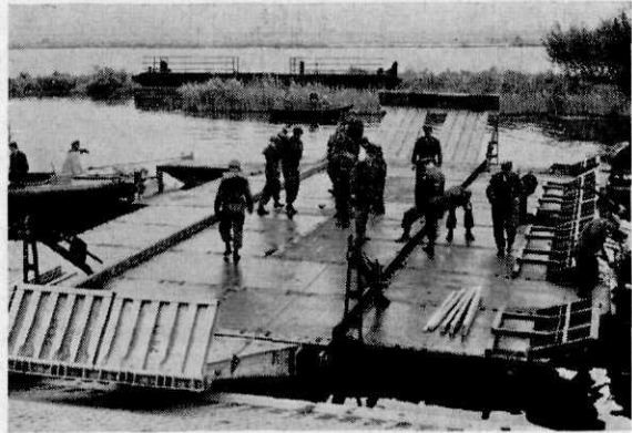
Pontonplaatbrugmaterieel. Een zojuist gereedgekomen klasse-50-tankvlot, voortbewogen door een duwboot, tijdens beproevingen
