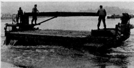
Amfibisch brugmaterieel M2. Het afzonderlijke element met uitgeklapte zijdrijvers, varende
