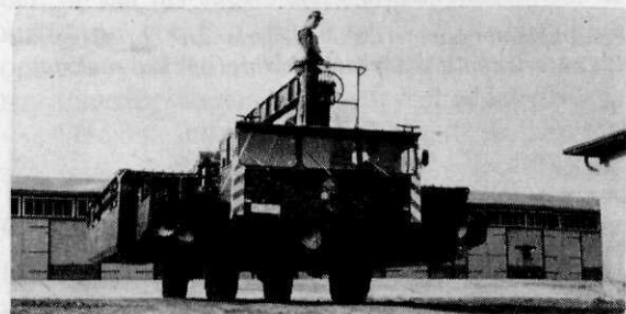
Amfibisch brugmaterieel M2. Het amfibische element met uitgeklapte zijdrijvers gereed voor het te water gaan
