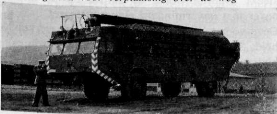
Amfibisch brugmaterieel M2. Het amfibische element gereed voor verplaatsing over de weg
