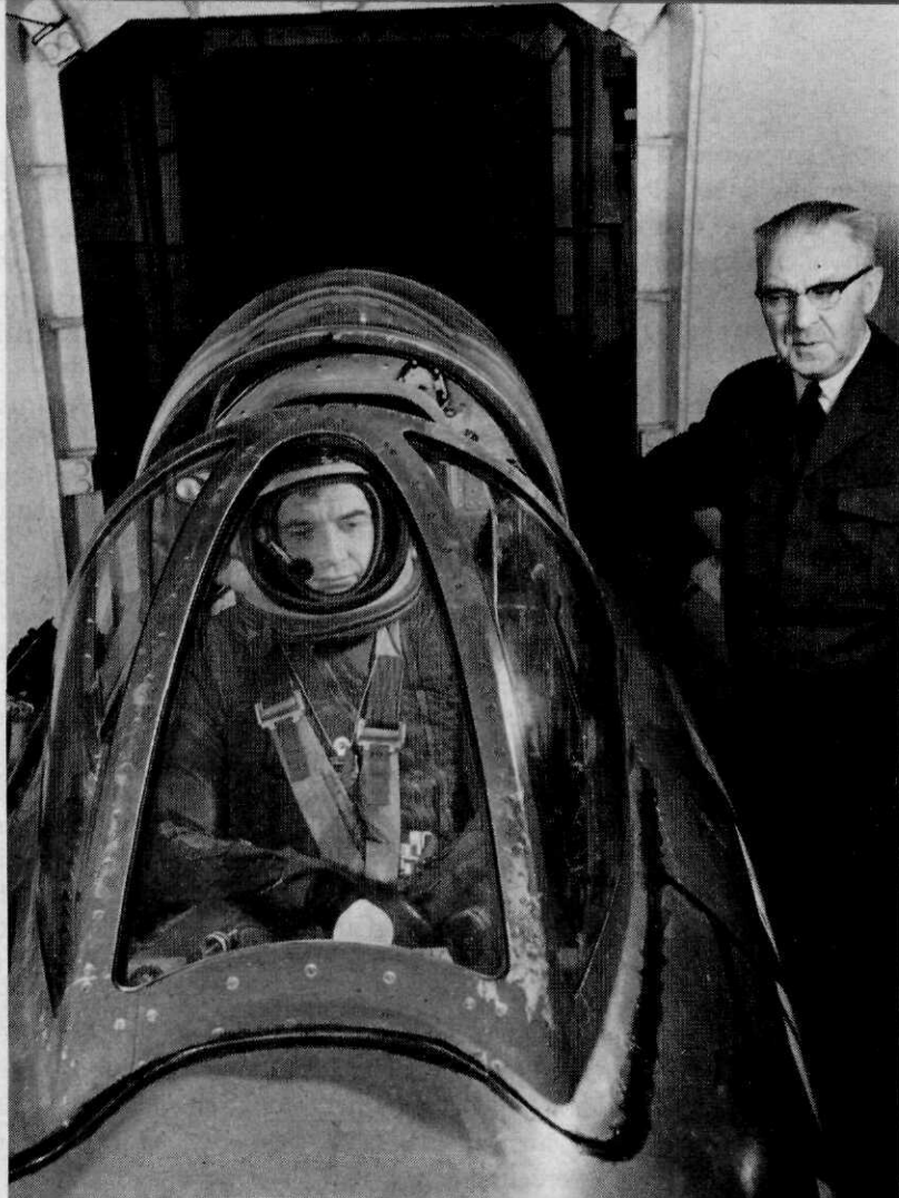
Afb. 3 Testen van drukpak in vliegtuigcockpit, geplaatst in onderdrukkamer van de Stichting Nationaal Luchtvaart Geneeskundig Centrum te Soesterberg, die wordt gebruikt voor indoctrinatie van de vliegers
