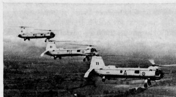
Westland Belvedere, een middelbare transporthelikopter, in gebruik bij de Engelse Marine (laadvermogen 2,7 t/19 man)
