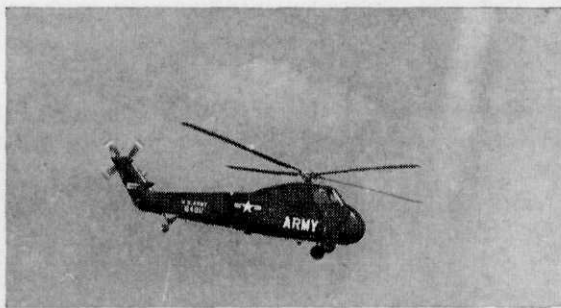
Sikorsky CH-34, een lichte transporthelikopter, in gebruik bij de Amerikaanse en Westduitse landstrijdkrachten (laadvermogen 2 1/18 man)
