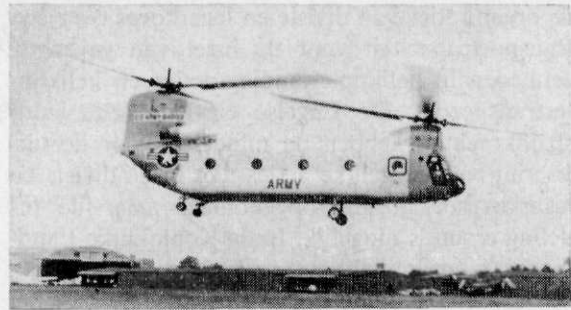
Boeing Vertol CH-47 „Chinook”, een middelbare transporthelikopter, in gebruik bij de Amerikaanse landstrijdkrachten, o.a. in Vietnam (laadvermogen 4 t/33 man)
