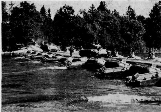
Schweizer Panzer 61 und Schützenpanzer (M113) überqueren die Schlauchbootbrücke
