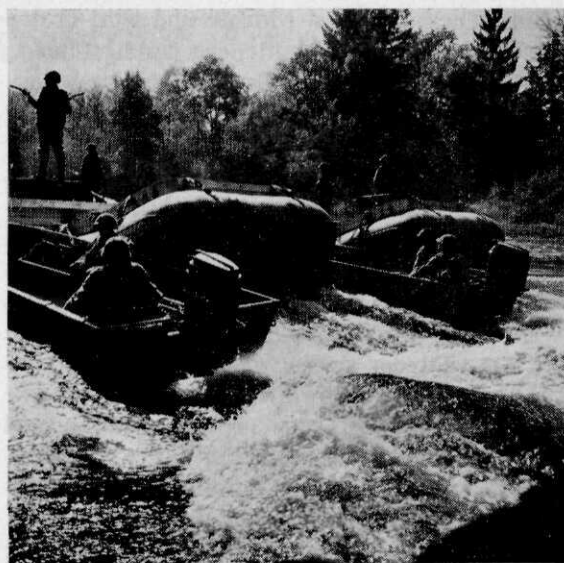
Einfahren von Elementen für die 50 Tonnen-Schlauchbootbrücke
