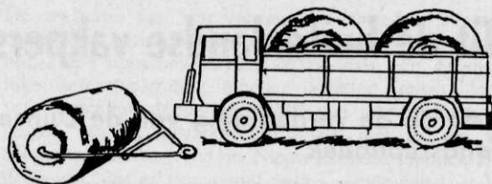
Afb. 2 Twee opvouwbare tanks, gemonteerd op een 3-tons truck; truck; links: opvouwbare tank met trekboom
