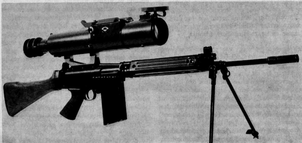
Afb. 5 Geweer 7.62 mm, FAL, met helderheidsversterker
