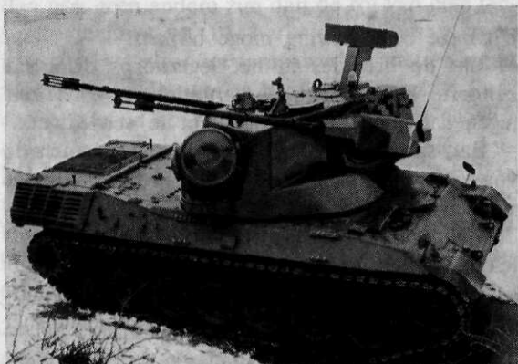
Afb. 3 Dubbelloops 30 mm Rheinmetall (mock-up op Leopard-onderstel)
