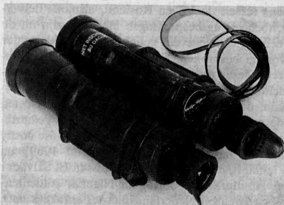
Binoculaire infraroodwaarnemingskijker B4 (kolom J uit de tabel)
