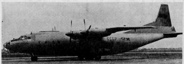
Afb. 1 De AN-12 CUB kan 90 parachutisten vervoeren; actieradius maximaal belast 1500 km, economisch belast 2500 km
