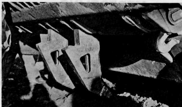
Afb. 3 De twee grote wroetertanden, bevestigd aan het dozerblad van de genietank
