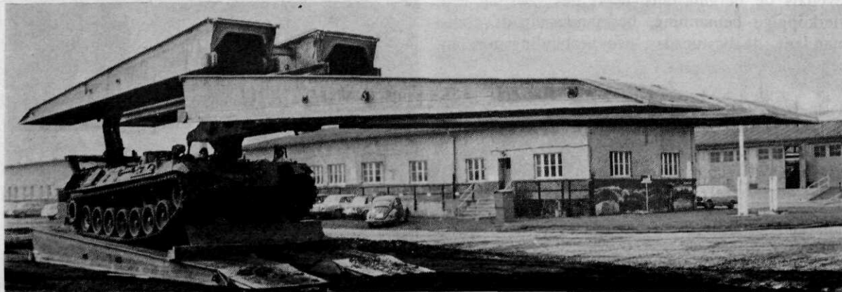
Afb. 7 Het lanceren van de brug
