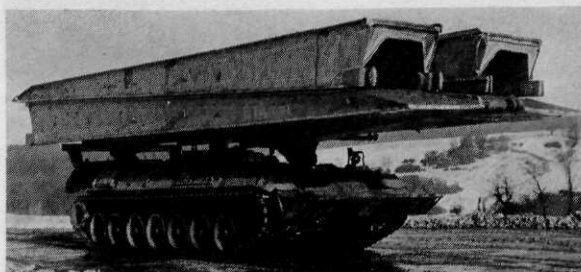
Afb. 6 De brugleggende tank
