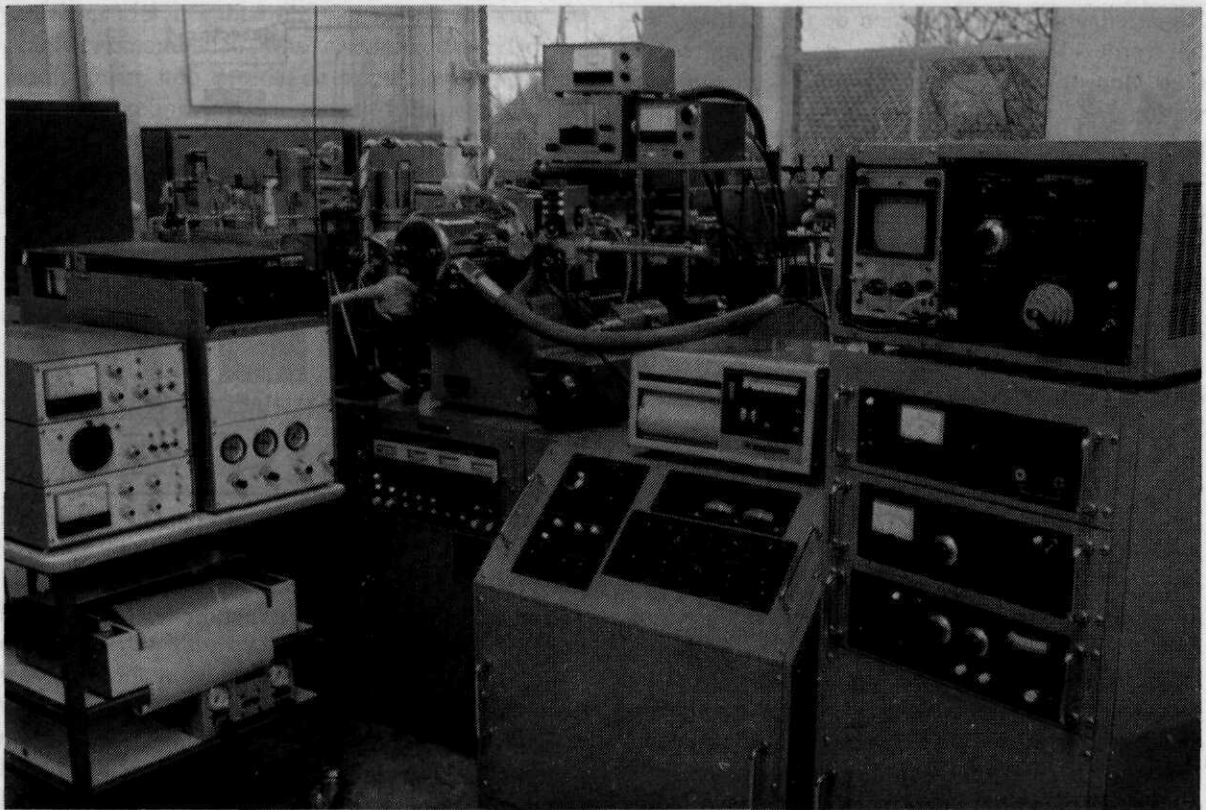
Afb. 5 Gaschromatograaf, gekoppeld aan een massaspectrometer
