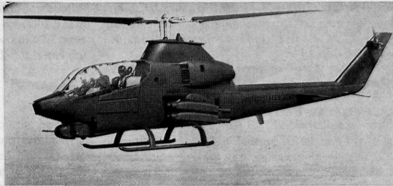
Afb. 8 Een helikopter, type UH-1B Huey attack-helikopter; de outdoor-pylons bevatten in totaal 8 antitank Tow-missiles
