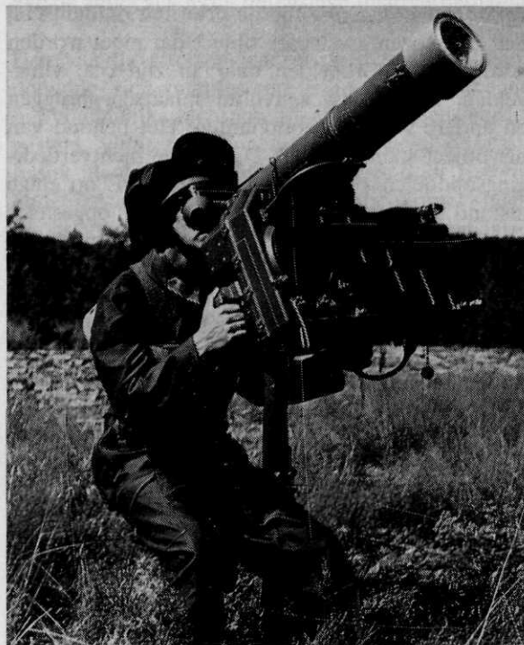
Afb. 7 Het Zweedse RBS-70-systeem, draagbaar in drie manlasten
