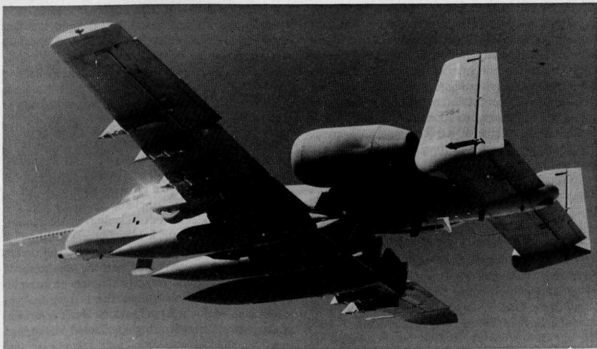
Afb. 1 De Fairchild Republic A-10 Thunderbolt II, het gespecialiseerde „close air support”-vliegtuig van de Amerikaanse luchtmacht; de foto laat duidelijk de onorthodoxe vormgeving zien
