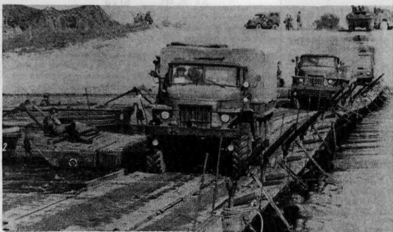
Afb. 11 Logistieke eenheden in de GSVG passeren de waterhindernis via de 20-tons PMP-brug
