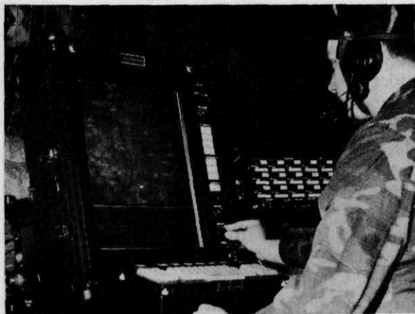
Afb. 11 Het beeld- en controlestation van het Marine Integrated Fire and Air Support System (MIFASS) van de firma Norden, dat in ontwikkeling is voor het US Marine Corps (foto Norden Systems)
