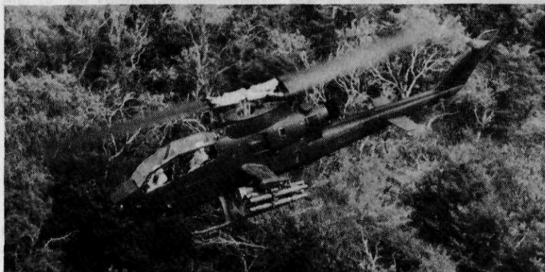
Afb. 6 De volledig gemoderniseerde gevechtshelikopter AH-1S Cobra, net boven de boomtoppen vliegende; duidelijk zijn de lanceerbuizen te zien van de Tow-antitankraketten en van de 2.75 inch raketten (Bell Helicopter foto)
