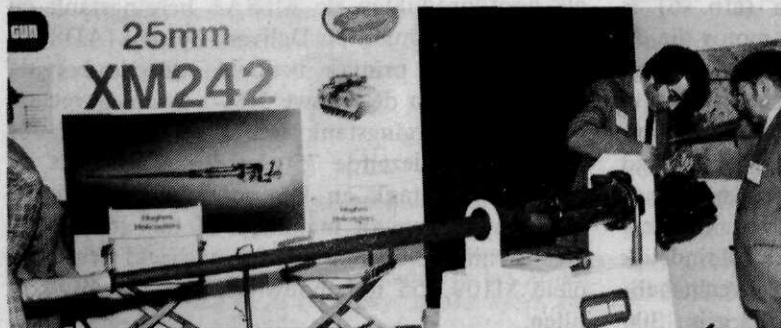
Afb. 9 Bij Hughes werd gedemonstreerd hoe in het 25 mm Chaingun XM242 de patroonaan- en afvoer en het afvuren zelf geschiedt met behulp van één simpele ketting, waarvoor aanvankelijk een normale ketting van een motorrijwiel werd gebruikt
