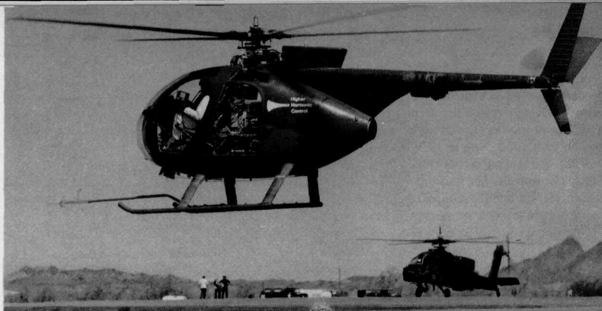
Afb. 10 Higher Harmonic Control (HHC) apparaat voor het elimineren van rotorvibraties, gemonteerd in een OH-6A helikopter bij een testvlucht; op de achtergrond een AH-64A gevechtshelikopter (foto Hughes Helicopters)
