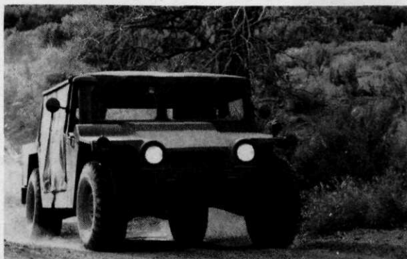
Afb. 11 Prototype van een High Mobility Multipurpose Wheeled Vehicle (HMMWV), gefabriceerd door de firma AM General, tijdens een proefrit (foto American Motors Corporation)
