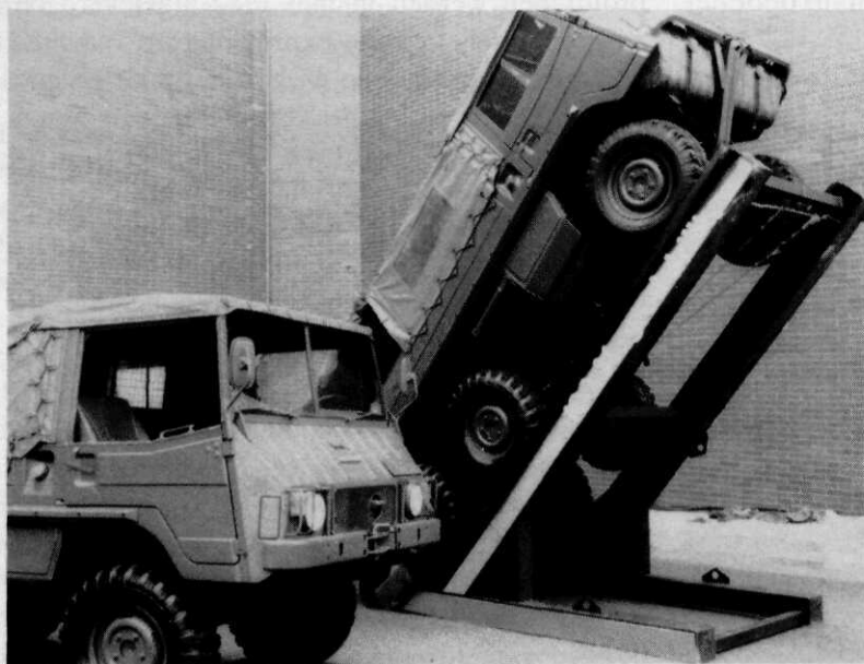
Afb. 13 Demonstratie van het Pinzgauer terreinvoertuig van de Oostenrijkse combinatie Steyr-Daimler-Puch op een 100%-helling.
