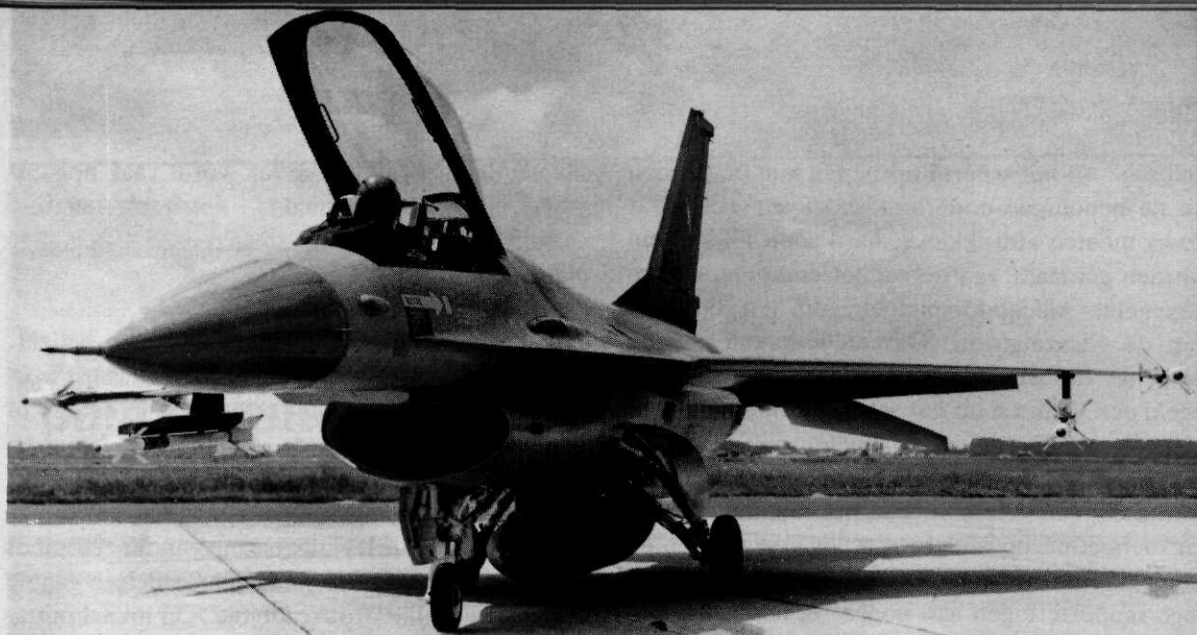
De F16A in een typische luchtverdedigingsconfiguratie, bewapend met vier Sidewinder lucht-luchtraketten; onder de romp bevindt zich een brandstoftank
