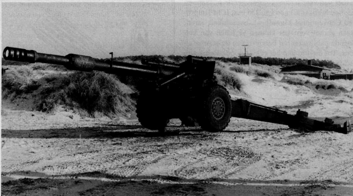
Het eerste prototype van de gemodificeerde vuurmond M 114
