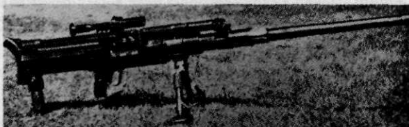
Afb. 13 De tankbuis Solothurn S 18-1000 op tweevoet; totale lengte van het wapen 216 cm; gewicht 54,43 kg; pantserdoorboring 35 mm op 300 m bij loodrecht treffen; houders van 5 of 10 patronen (volscherp); kaliber 20 mm; vuursnelheid ca. 10 sch/min (foto: SMG)
