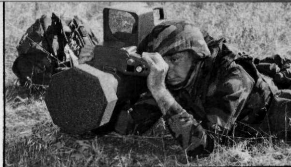
Afb. 6 Demonstratie van een model van het Advanced antitank weapon system medium (AAWS-M); dit is de uitvoering van de Ford Aerospace and Communications Corporation, waarbij van lasergeleiding gebruik wordt gemaakt (foto Ford Aerospace)
