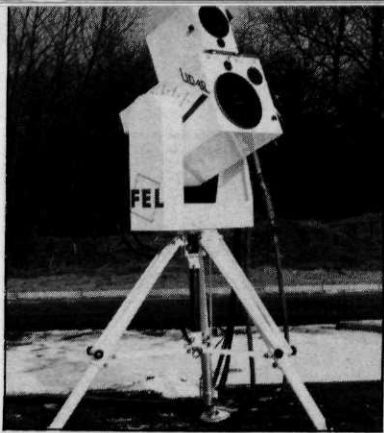
◀ Door het FEL ontwikkelde Lidar-apparatuur werkt analoog aan een radarsysteem, doch bij optische golflengten (1,06 \mu\text{m} )
