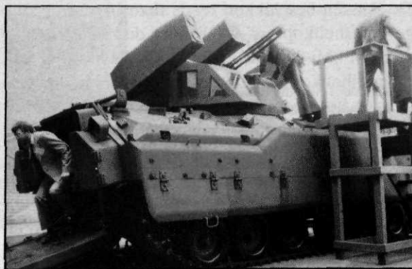
Afb. 3 Bezoekers komen en gaan bij de demonstratie van de „Blazer”, een door de firma General Electric voorgestelde luchtverdedigingstank, bewapend met vier Bofors RBS-70 lasergeleide raketten, vier Stinger-raketten en 450 stuks 25 mm antiluchtdoelprojectielen, die uit de vijfloops General Electric „Gatling”-mitrailleur worden verschoten met een vuursnelheid van 40 schoten/sec
