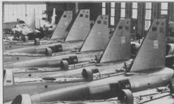
Afb. 3 In tegenstelling tot eerdere vliegtuigprojecten was licentiebouw of eindassemblage van de NF-5 bij Fokker niet haalbaar door de beperkte serie; wel konden in het kader van de compensatie bij Avio-Diepen op Ypenburg 190 rompmiddenstukken voor de Nederlandse en Canadese toestellen worden vervaardigd
