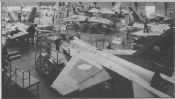
Afb. 4 De fabriekshal van Fokker op Schiphol, waar de Nederlandse en Noorse F-16's werden geassembleerd uit delen afkomstig van de vijf deelnemende landen, om vervolgens te worden ingevlogen en afgeleverd
