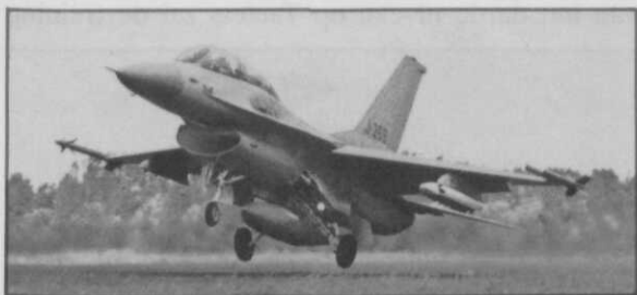
De F-16B-tweezitter wordt gebruikt voor opleiding van wapen- en vlieginstructeurs en begeleiding van training op het derde niveau
