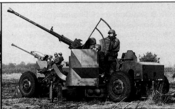
Afb. 1 Flycatcher/40L70 , een wapensysteem bestaande uit het geïntegreerde radar- en vuurleidingselement Flycatcher (foto links), waaraan drie kanonsystemen van het type 40L70 (foto rechts) worden gekoppeld. Flycatcher is een radar/vuurleidingssysteem voor korte afstand en geringe hoogte. Het detecteert in een sector van 360^\circ . De rondzoek- en doelvolgsensor zijn in één container ondergebracht. Het systeem dateert uit de jaren '70 en ondergaat thans een midlife update , waarbij doelvolgcapaciteit en -mogelijkheden en de ECCM -capaciteit worden verbeterd. De 40L70 is een door Flycatcher gestuurd automatisch kanonsysteem met een kort afstands bereik. Onderscheppingen vinden plaats over 360^\circ . Het kaliber is 40 mm. De munitie, voorzien van impact of proximity fuses , maakt onderschepping van vliegtuigen en helikopters mogelijk
