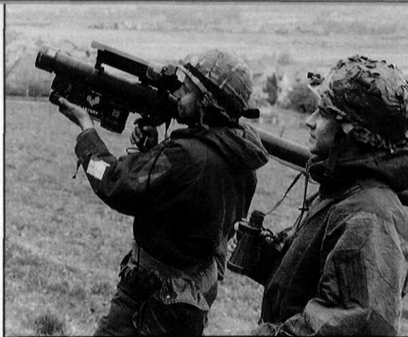
Afb. 5 Stinger is een infraroodgeleid luchtverdedigingswapen voor zeer geringe hoogte en zeer korte afstand. Het is een Man portable air defence (Manpad)-systeem, waarbij detectie en onderscheppingssector hoofdzakelijk worden bepaald door het heersende (visuele) zicht. De Stinger-systemen worden op korte termijn vervangen door Stinger-Post; dit systeem maakt voor de geleiding behalve van het infrarode ook gebruik van het ultraviolette deel van het elektronische spectrum, waardoor het wapen niet of nauwelijks is te storen
