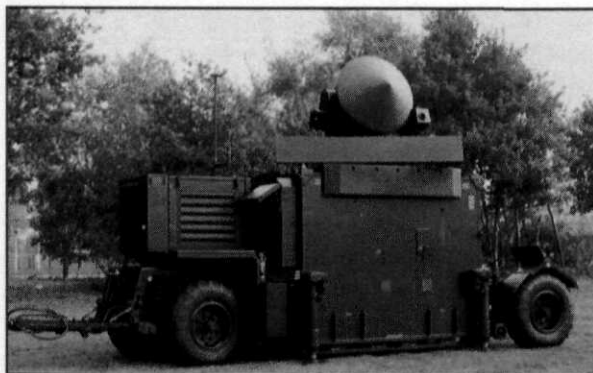
Afb. 1 Flycatcher/40L70 , een wapensysteem bestaande uit het geïntegreerde radar- en vuurleidingselement Flycatcher (foto links), waaraan drie kanonsystemen van het type 40L70 (foto rechts) worden gekoppeld. Flycatcher is een radar/vuurleidingssysteem voor korte afstand en geringe hoogte. Het detecteert in een sector van 360^\circ . De rondzoek- en doelvolgsensor zijn in één container ondergebracht. Het systeem dateert uit de jaren '70 en ondergaat thans een midlife update , waarbij doelvolgcapaciteit en -mogelijkheden en de ECCM -capaciteit worden verbeterd. De 40L70 is een door Flycatcher gestuurd automatisch kanonsysteem met een kort afstands bereik. Onderscheppingen vinden plaats over 360^\circ . Het kaliber is 40 mm. De munitie, voorzien van impact of proximity fuses , maakt onderschepping van vliegtuigen en helikopters mogelijk
