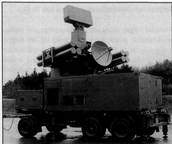
Afb. 2 Crotale is een radar- en elektro-optisch geleid luchtverdedigingssysteem voor korte afstand en geringe hoogte. Detectie en onderschepping vinden plaats in een sector van 360^\circ . De rondzoek- en doelvolgsensoren zijn samen met de raketlanceerinrichting in één container ondergebracht. Het is een uiterst modern systeem met zeer hoge reactie- en vuursnelheid en uitstekende elektronische en elektro-optische anti-storingsmogelijkheden. Het kan alleen of geïntegreerd met andere Crotale NG -systemen of met Flycatcher/40L70 worden ingezet
