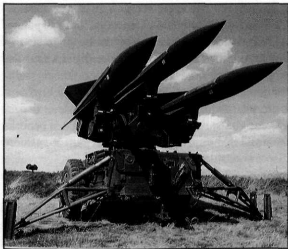
Afb. 4 Hawk is een radargeleid luchtverdedigingssysteem voor geringe en middelbare hoogte en middelbare afstand. Detectie en onderschepping vinden plaats in een sector van 360°. Het systeem wordt door verbeteringsprogramma's op operationeel aanvaardbaar niveau gehouden. Het is in staat tot enkelvoudige onderscheppingen van vliegtuigen en helikopters. Koppeling aan Patriot ICC is mogelijk. Door elektronische uitwisseling van gegevens met Patriot is onderlinge integratie mogelijk, waardoor de systemen elkaar ondersteunen en aanvullen. Tevens wordt daardoor de inzet van het Hawk-systeem verbeterd en wordt overkill voorkomen
