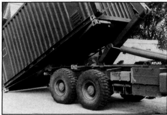
Afb. 5 Detail van Duits wissellaadsysteem
