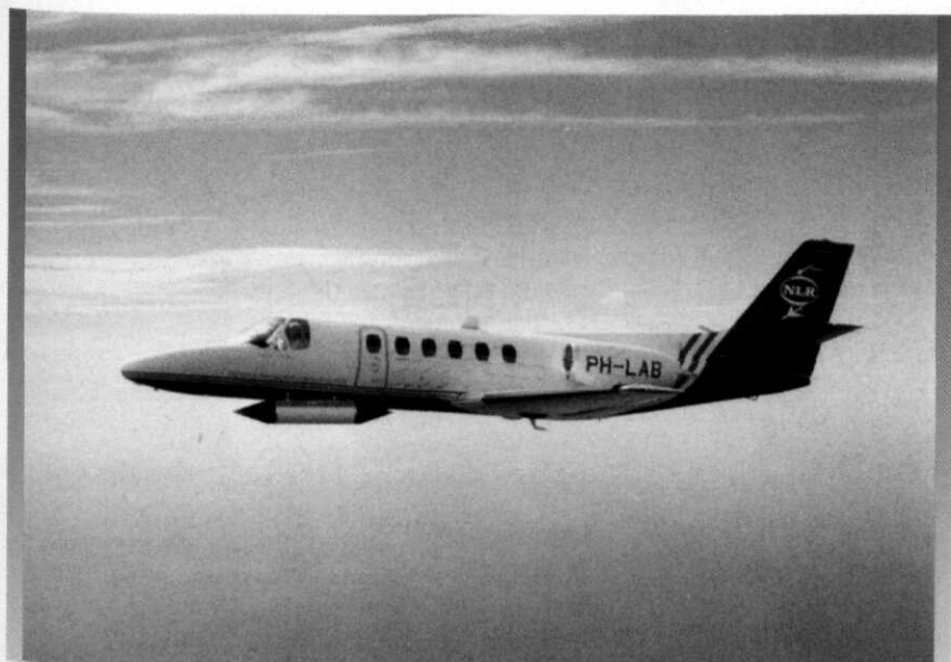
Afb. 4 Cessna Citation research-vliegtuig met PHARUS-gondel
