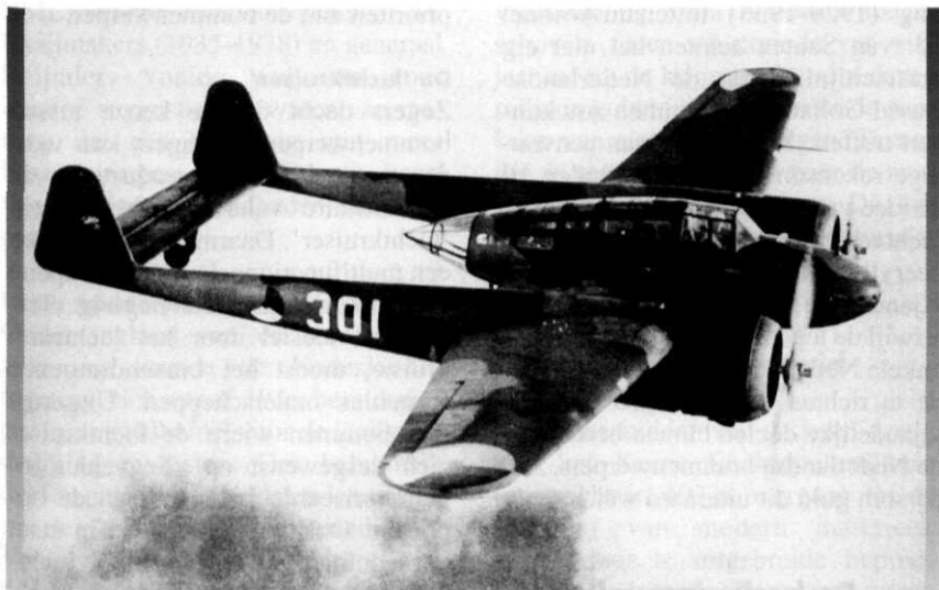
Afb. 2 De tweemotorige jachtkruiser Fokker G1A was met een actieradius van 1500 km geschikt voor het Nederlandse patrouillesysteem
