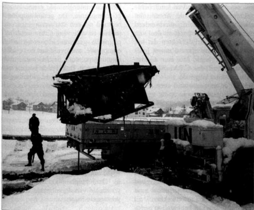
Afb. 3 Sneeuw- en ijsvrij houden van wegen met door Rijkswaterstaat geschonken zoutstrooiers op NL-10 tonner in Bosnië
