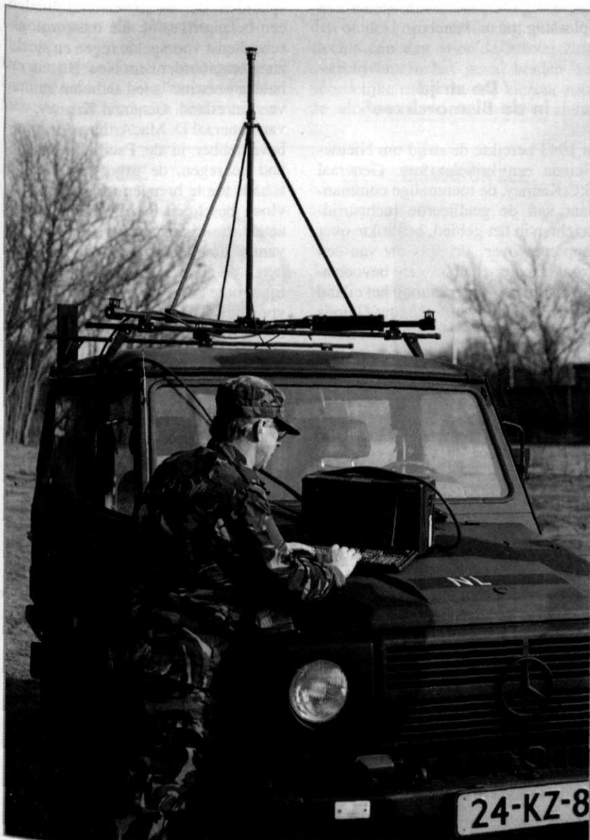
Afb. 5 Het microfoon array op het imperiaal van een KL-halftonner
