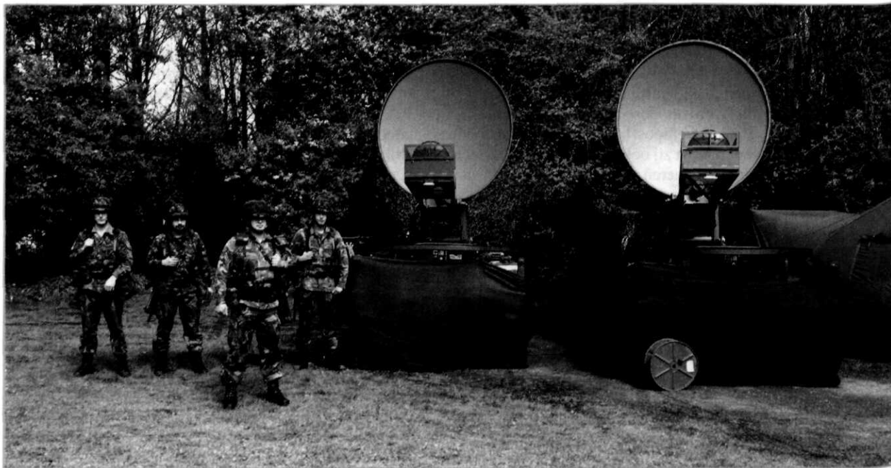
Afb. 5 De moderne AIR-VSAT installaties van 11 Vbdat MND(C). Deze satellietinstallaties kunnen zeer grote afstanden overbruggen en kunnen per helikopter worden getransporteerd
