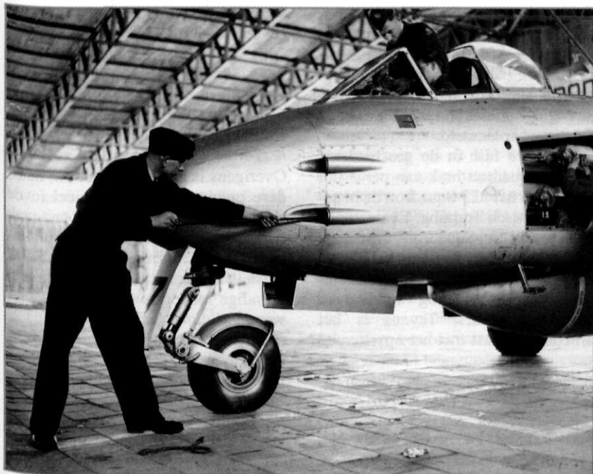
Afb. 4 Het schoonmaken van de kanonlopen van een Meteor (Leeuwarden 1949). Aan weerszijden van het voorste rompsegment was de Meteor uitgerust met twee British-Hispano Mk 5 snelvuurkanonnen (Foto: Sectie Luchtmachthistorie)
