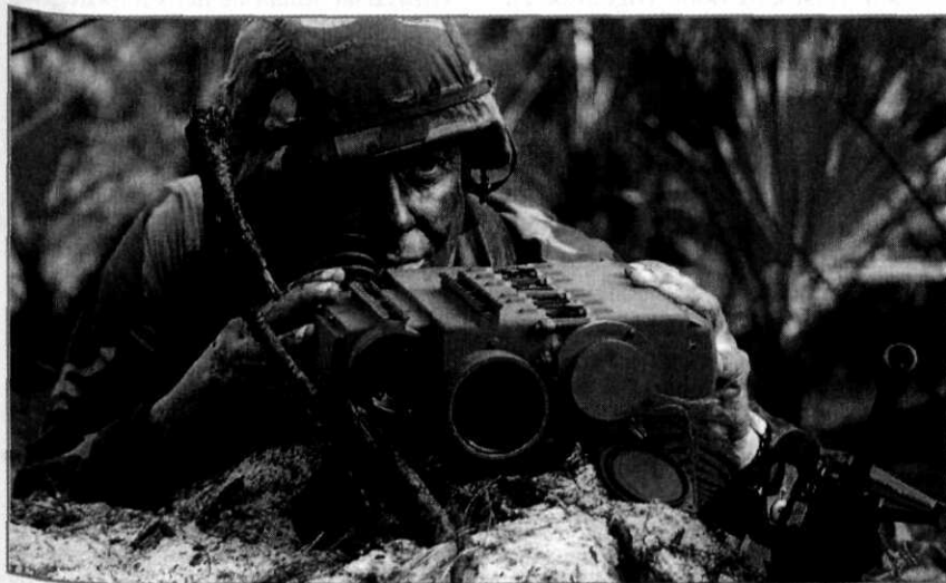
Afb. 5 De Amerikaanse AN/PEQ-1 Laser Target Designator is één van de mogelijke kandidaten voor invoering bij de Nederlandse Tactical Air Control Parties
