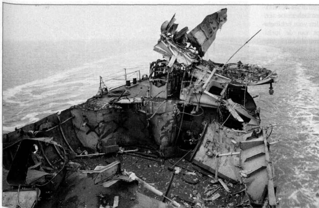
Afb. 2 Het resultaat van beproevingen (jaren tachtig) met een fregat van de Roofdier-klasse. Voor het Luchtverdedigings- en Commandofregat (LCF) zijn door TNO explosiebestendige schotten ontwikkeld. Onderzoek naar explosiebestendige deuren vindt nog plaats
