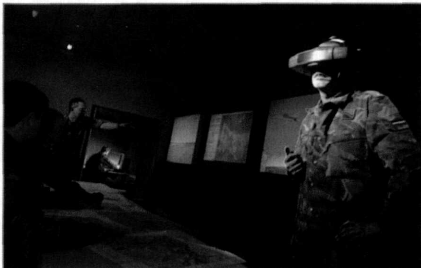
Afb. 4 Door TNO is een simulatorconcept beproefd waarmee de 'Forward Air Controller' (FAC) zich in het klaslokaal kan voorbereiden op het echte werk. Een 'Head Mounted Display' brengt de FAC in een virtueel oefenterrein terwijl tegelijkertijd zijn medecursisten leren door middel van de meekijkschermen. Capaciteit en kwaliteit van de opleiding kunnen met de simulator worden verhoogd
