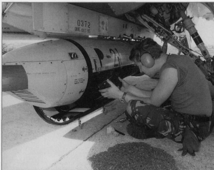
Een KLu-militair werktend aan het Orpheus-systeem op de Italiaanse vliegbasis Villafranca (Bron: Sectie Luchtmachthistorie, Staf BDL)
