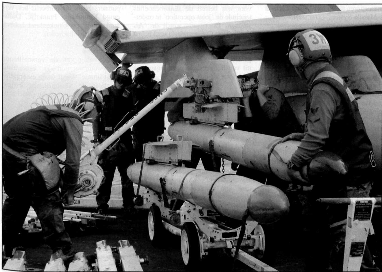
Een HARM-raket wordt bevestigd aan een vleugel van een F/A-18C Hornet aan boord van USS Theodore Roosevelt
