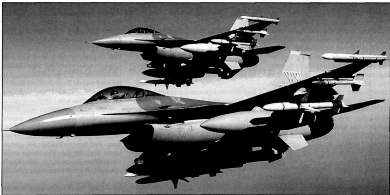
F-16C. Van binnen naar buiten: HARM, Sidewinder, AMRAAM. Centraal onder het vliegtuig de HTS (Harm Targeting System)
