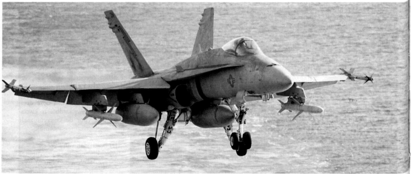
Een F/A-18C Hornet keert terug van een missie in de Golfregio. Aan de uiteinden van de vleugels zijn 'Sidewinder'-raketten bevestigd, en onder de vleugels 'HARM'-raketten, bedoeld om vijandelijke luchtverdedigings-systemen die met radar zijn uitgerust, op te sporen en te vernietigen (Foto: US NAVY, S. Dallal; collectie: IMG/KI)
